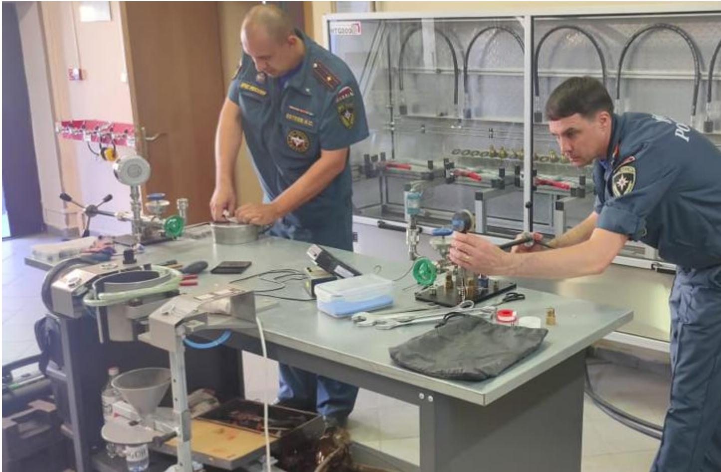
На базе лаборатории по обслуживанию средств индивидуальной защиты Управления радиобиологической защиты, сотрудники Центральной базы измерительной техники МЧС России манометров Центра. Специалисты ЦБИТ проверяют приборы, которые измеряют давление аппаратов, являющиеся неотъемлемой частью пожарных и газоспасательных отделений управлении РХБ защиты предстоит проверить более 70 единиц средств измерения.
