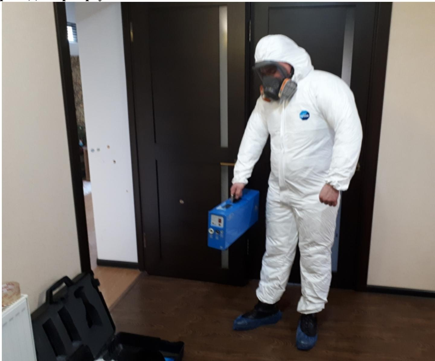
1 января расчет радиационной и химической разведки Центра «Лидер» привлекался для проведения замеров ПДК паров ртути. По прибытию специалисты обследовали жилое помещение, был произведен замер концентрации паров ртути анализатором РА-915+. В ходе проведения замеров превышение ПДК паров ртути не выявлено.
