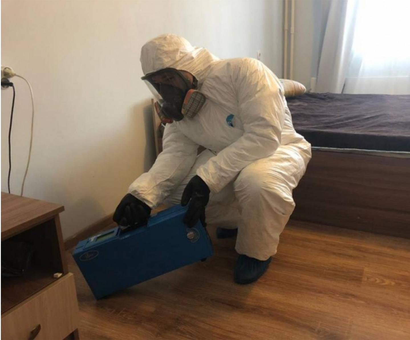
13 февраля расчет радиационной и химической разведки Центра привлекался для проведения замеров концентрации паров ртути и проведению демеркуризации загрязненного участка по адресу: г. Москва, г. Московский, ул. Радужная. В ходе работ проведен замер концентрации паров ртути, превышение ПДК в 2 раза. Проведена демеркуризация загрязненного участка, при повторном замере ПДК паров ртути не превышена.
