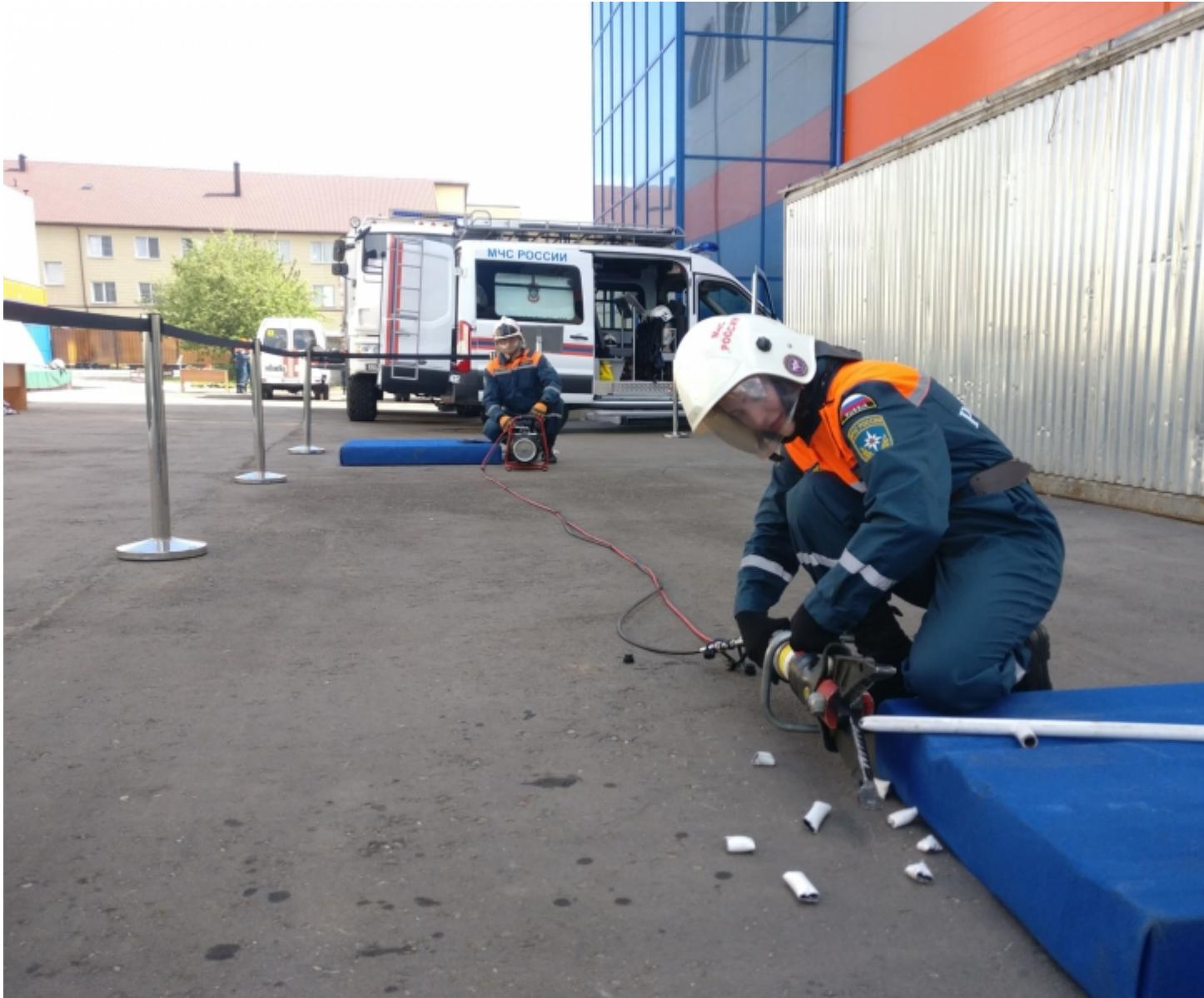
На одной из учебных точек при сдаче специальной подготовки личному составу необходимо в установленное время подготовить к работе гидравлический аварийно-спасательный инструмент и совершить перекусывание стального прута, а также выполнить задачу по распилу и резке других металлических конструкций. При сдаче норматива личный состав показал отличные знания и навыки при работе с инструментом.
