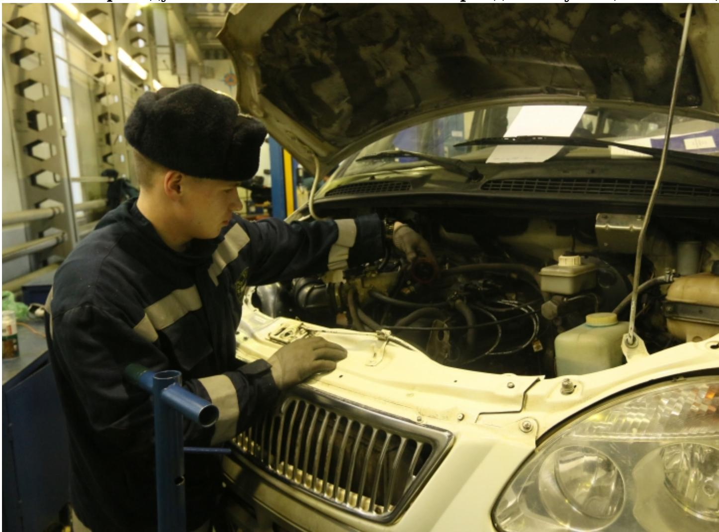
В Центре началась подготовка к переводу техники на весенне-летний период эксплуатации в 2018 году. В течение этого времени будут проводиться мероприятия по подготовке техники, средств обслуживания и ремонта. В рамках планового обслуживания техники проверяются узлы и агрегаты каждой боевой машины. Проводится промывка фильтров, замена ГСМ, ремонт и обслуживание аккумуляторных батарей, а также проверка электрооборудования.
