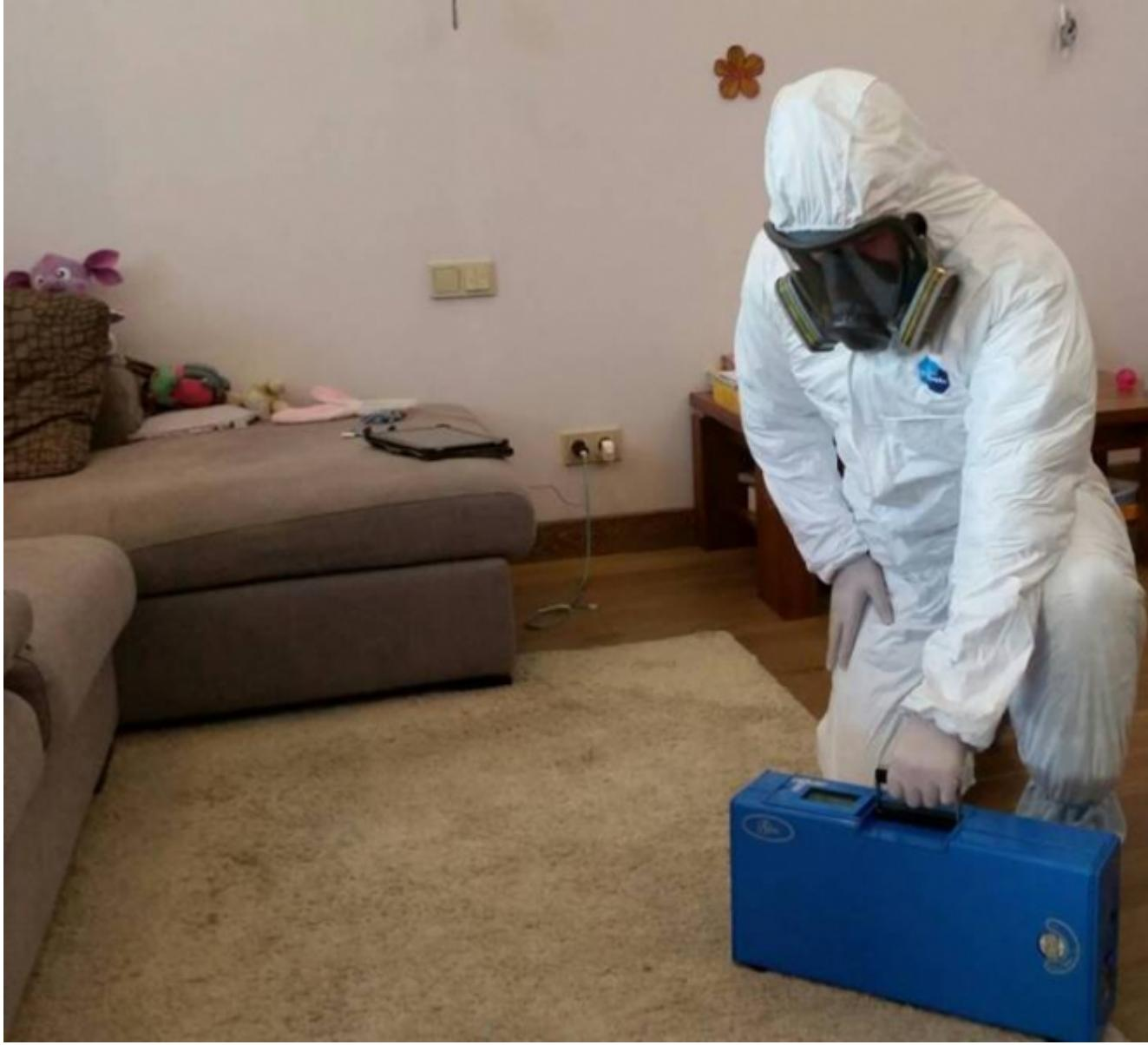
10 января расчет радиационной и химической разведки Центра привлекался для проведения замеров ПДК паров ртути по адресу: г. Москва, ул. Академика Виноградова, д. кв. 290. В ходе проведения работ установлено незначительное превышение концентрации паров ртути. Заявитель от проведения демеркуризации отказался.
